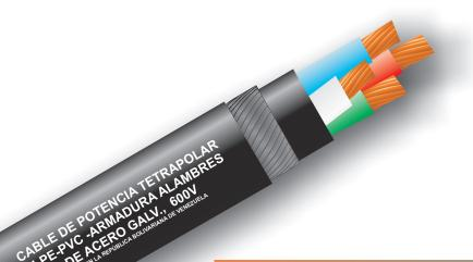
CABLE DE POTENCIA TETRAPOLAR XLPE-PVC ARMADURA ALAMBRES DE ACERO GALV., 600V
